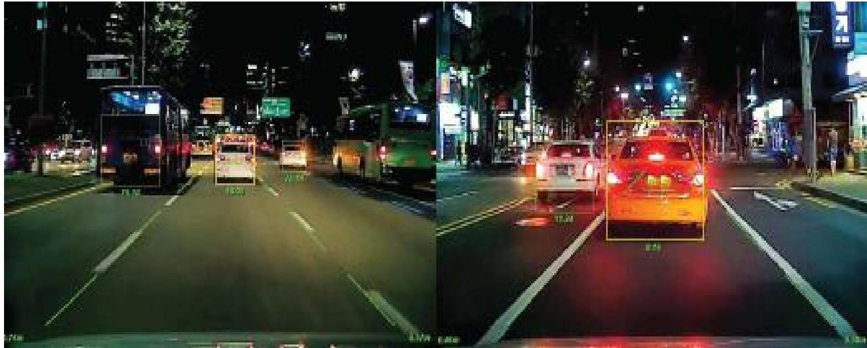
Устройство распознает транспортное средству спереди по ходу движения и рассчитывает время до столкновения с ним. В случае, если время до столкновения меньше порогового, формируется тревожное сообщение, звучит сигнал и появляется соответствующее изображение на дисплее водителя.
