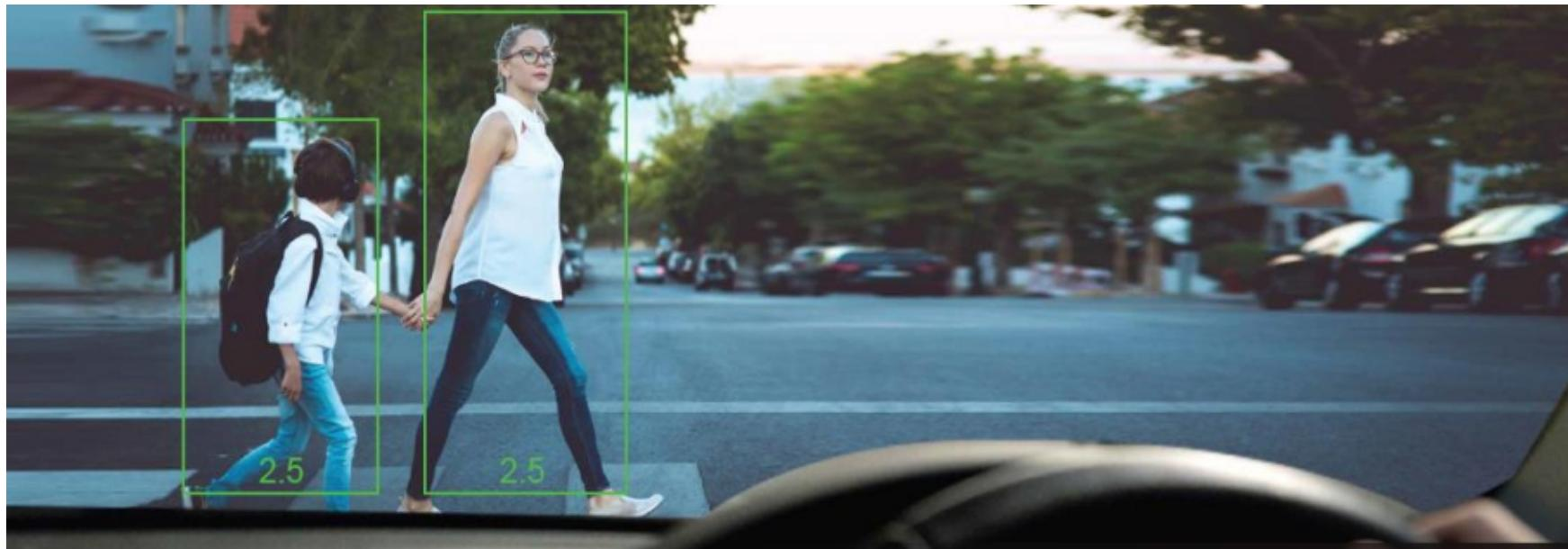
Устройство определяет наличие пешеходов, велосипедистов и других объектов, отличных от автомобиля в непосредственной близости спереди. В случае опасного сближения с объектом и уменьшения времени до столкновения система сигнализирует водителю звуком и на дисплее, а также формирует тревожное сообщения для отправки на сервер.
