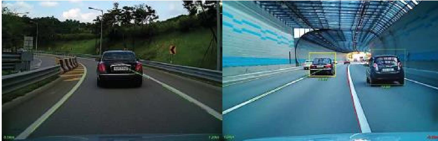
Во время движения устройство распознает параллельную разметку, прерывистую или сплошную, а также постоянно следит за соблюдением бокового интервала и пересечении линии разметки без включенного указателя поворота. При опасном приближении к линии разметки или пересечении ее без указателя поворота, устройство сигнализирует водителю и формирует тревожное сообщение для отправки на сервер.
